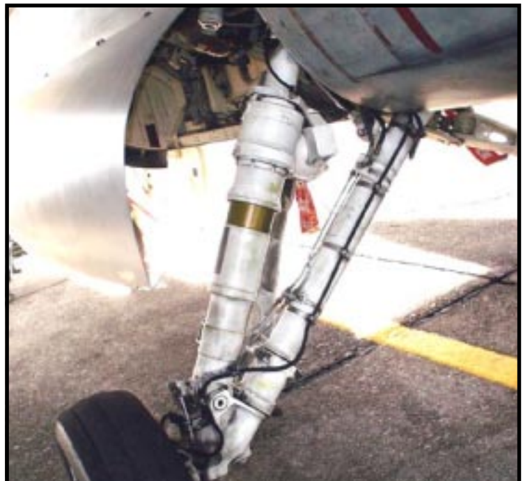
Notar o encaixe do tubo de fluido no sistema de freio
