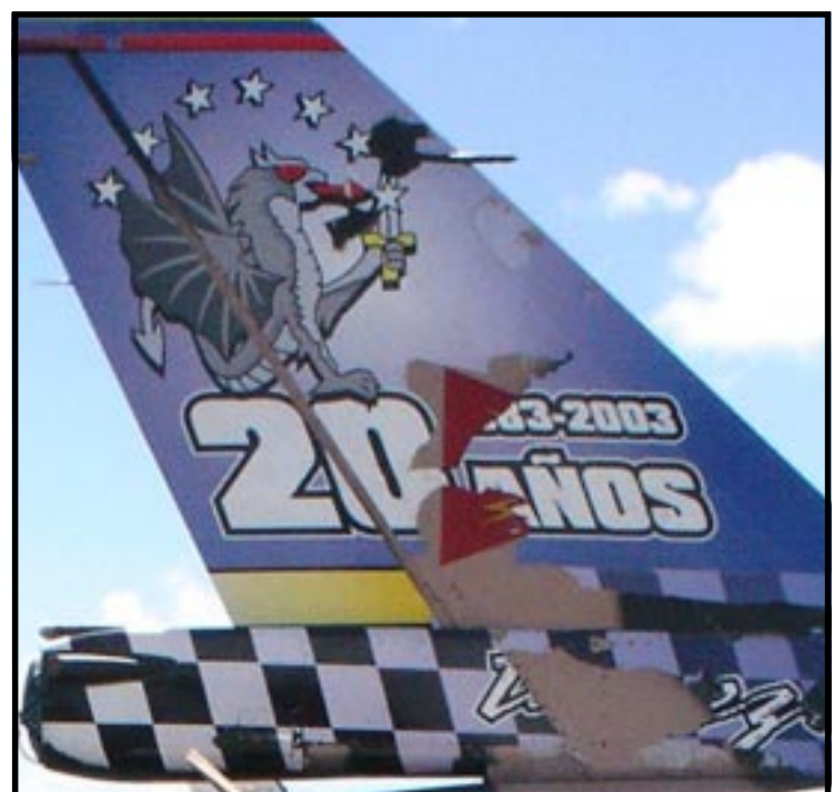
Observar o desgaste, trata-se de um adesivo sobre a pintura normal
