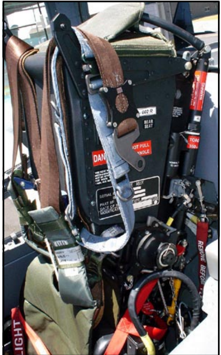
Nestas duas fotos, detalhes do assento ejetável do AT-29 Notar que os cintos ficam por cima da parte superior do assento
