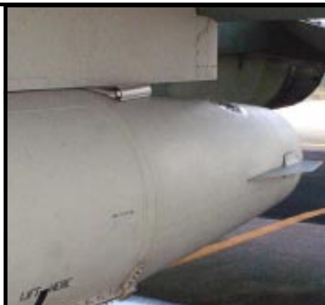
Notar a parte traseira do tanque que é reta, a diferença entre o tanque e o pylon e detalhes da aleta. Noutras fotos ver a frenel do tanque
