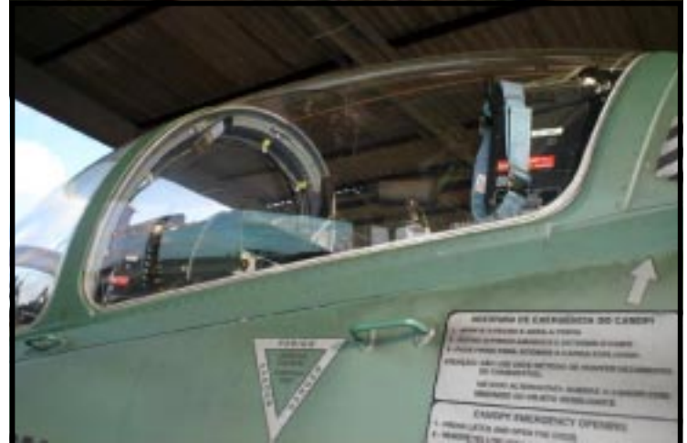
Parte traseira do canopy. Notar alças de apoio e de abertura
