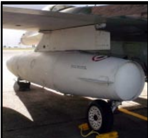
Notar a parte traseira do tanque que é reta, a diferença entre o tanque e o pylon e detalhes da aleta. Noutras fotos ver a frenel do tanque
