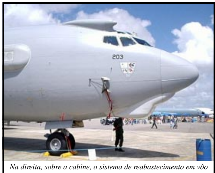
Detalhe do sistema de reabastecimento em voo. A sonda fica retraída e embutida na parte superior da fuselagem
