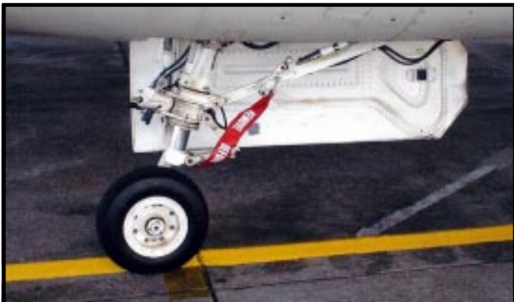
A inclinação da perna da bequilha é bem notada nesta foto
