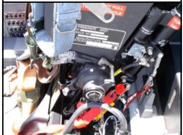
Nestas duas fotos, detalhes do assento ejetável do AT-29 Notar que os cintos ficam por cima da parte superior do assento
