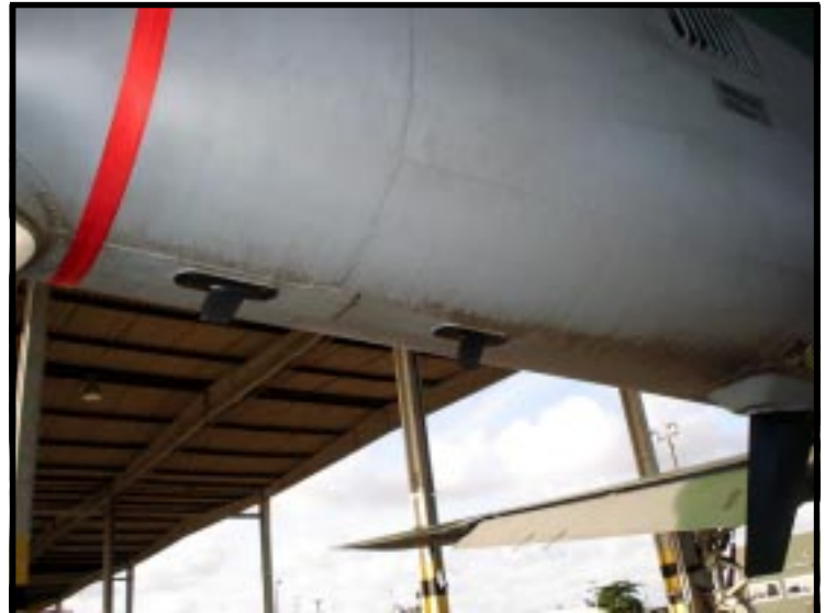
Detalhe das antenas sob a fuselagem traseira
