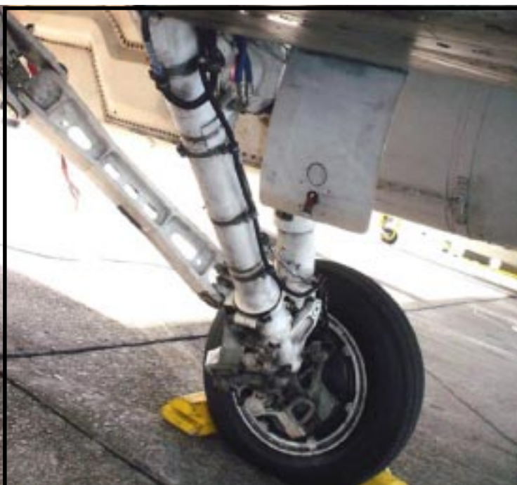
Vários detalhes, notar o tubo de fluido de freio
