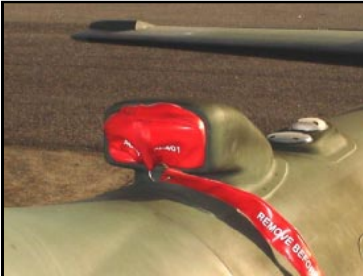
Detalhe da antena por trás da entrada de ar do ar-condicionado
