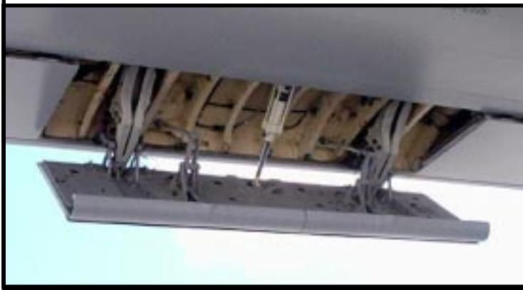
Nestas quatro fotos, detalhes dos "slats" das asas do E-3 Sentry. Quem se habilita a fazer na 1:72?
