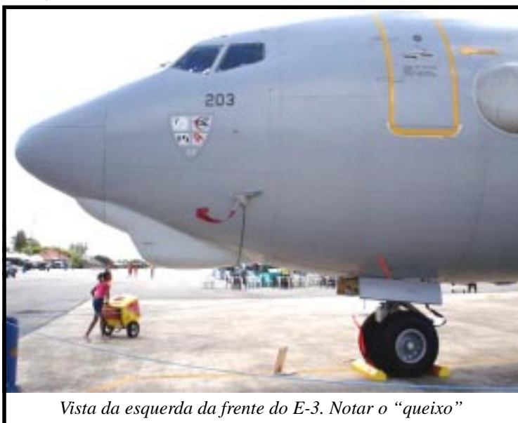
Na direita, sobre a cabine, o sistema de reabastecimento em voo
