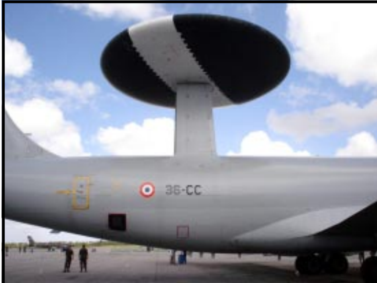
O imponente radar rotativo sobre o dorso do E-3
