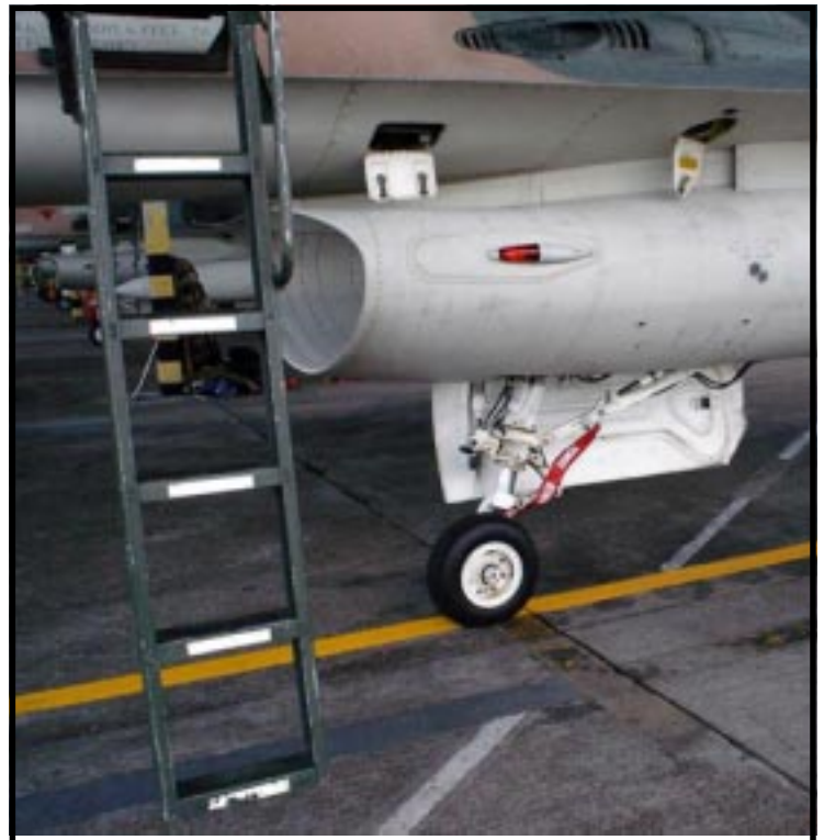
Escada, bequilha e mais janelas de acesso abertas
