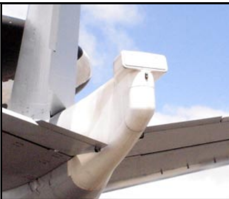
Nestas duas fotos, detalhes da antena que se prolonga no final da fuselagem do E-3. Está pintada de branco
