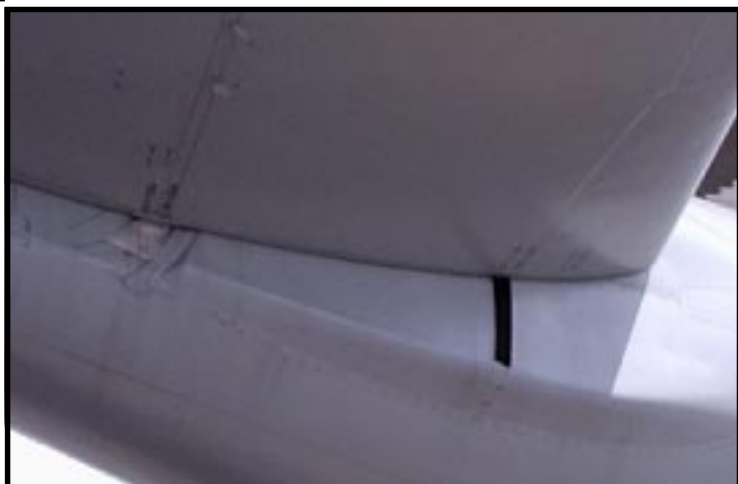
Encaixe do estabilizador na fuselagem, notar o guia (em preto)
