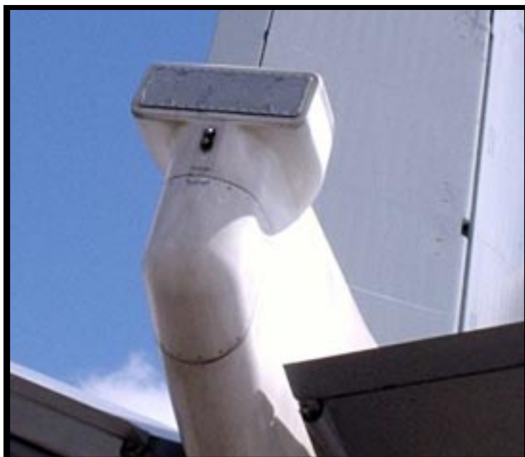
Nestas duas fotos, detalhes da antena que se prolonga no final da fuselagem do E-3. Está pintada de branco
