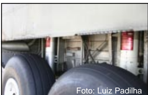
Sem a tampa. Notar amortecedores
