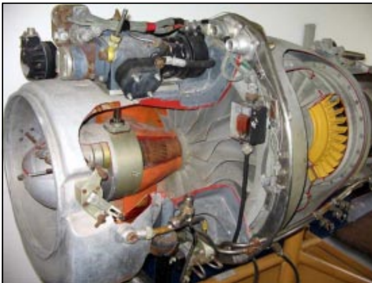
Turbina do Paris, seccionada mostrando seu interior
