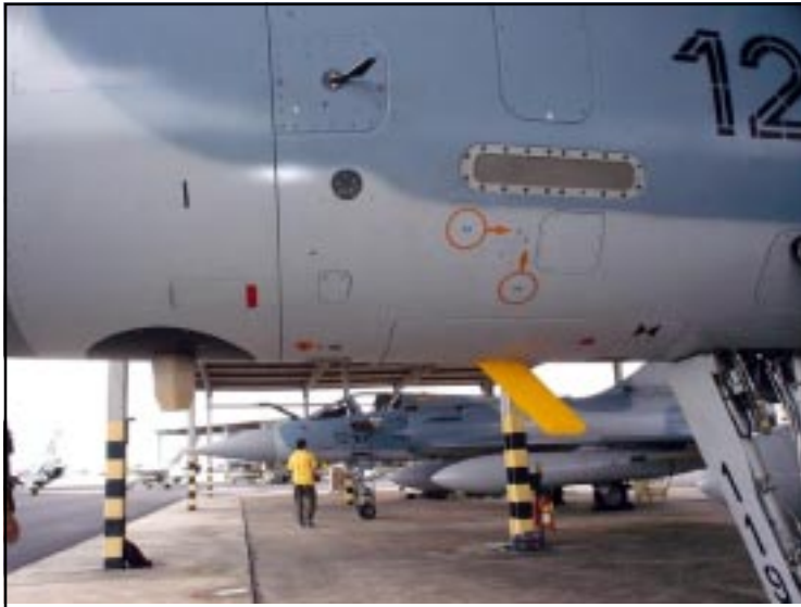
Notar antenas embaixo da aeronave
