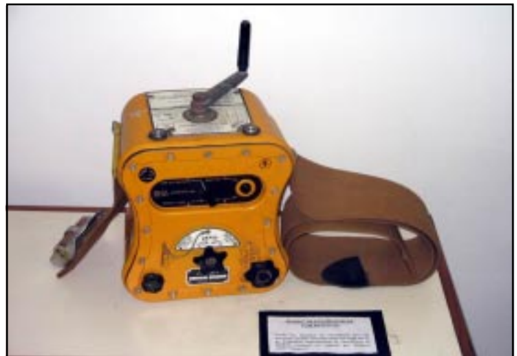
Gibson Girl, como era conhecido o rádio de emergência que ia no bote salva-vidas de aeronaves como SB-17 e Catalina
