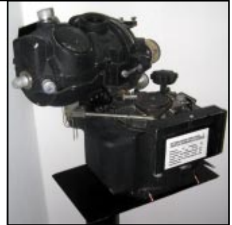
Aqui, duas vistas do famoso visor de bombardeiro NORDEN, que equipou a maioria dos bombardeiros americanos na Segunda Guerra Mundial
