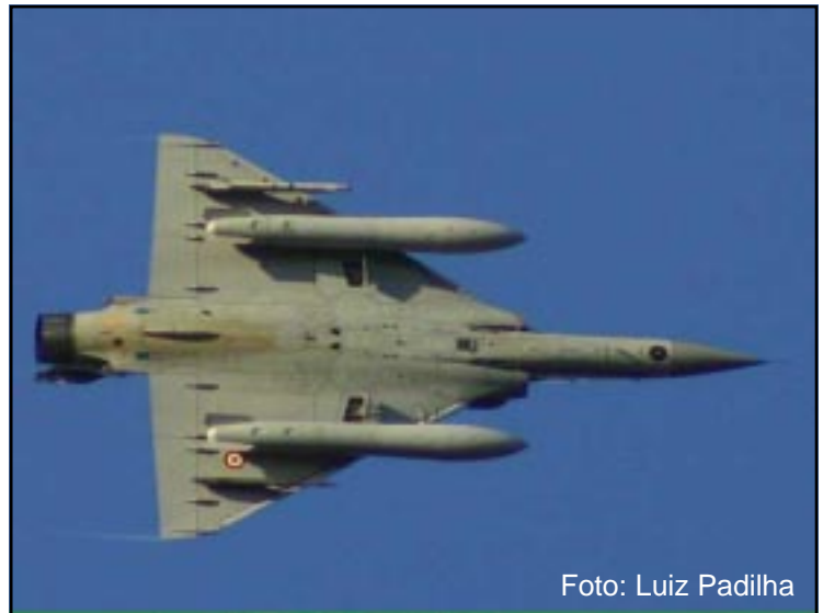
Visão inferior do Mirage 2000 C. Notar o formato dos tanques e os freios aerodinâmicos acionados
